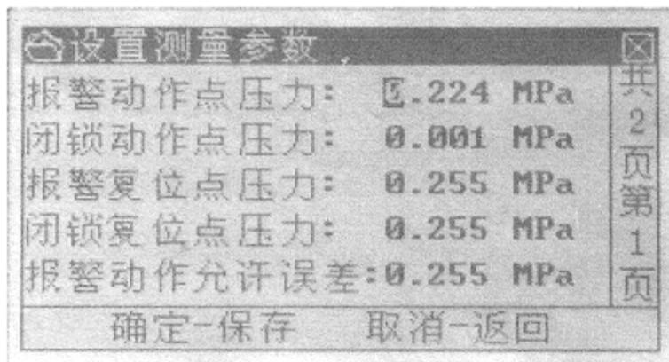
按【▲】、【▼】、【<】、【>】键，可以移动光标，按【+】、【-】键可以对焦点处的数值进行修改。按【确定】键将保存参数，按【取消】键将返回主界面。
