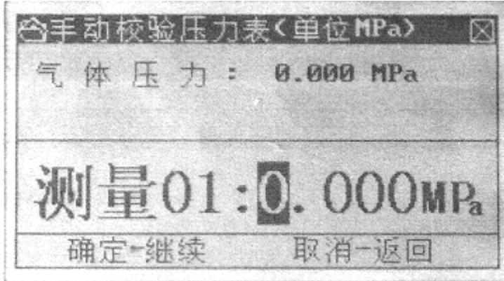
按【<】、【>】键，可以移动光标，按【+】、【-】键对当前光标所在位置的数值进行修改，输入当前压力表实际压力后，按【确定】键继续检测下一个压力点，直到所有要检测的压力点全部校验完毕，系统将显示校验结论：
