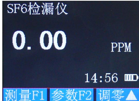
按 **F1** 仪器开始和停止测量数据，**▲** 键数据调零，**F2** 键进行参数设置，如下图所示：
